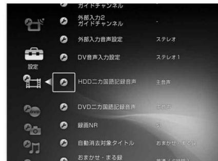
Appuyez sur  $\overline{\text{yy}}$  pour sélectionner « Enregistrement audio double langue sur disque dur
